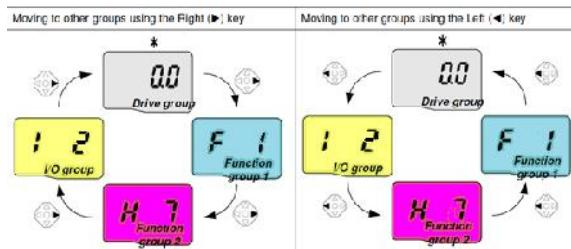
برای جابجایی بین پارامترهای هرگروه از دکمه‌های UP و DOWN واقع بر روی پنل استفاده نمایید.
