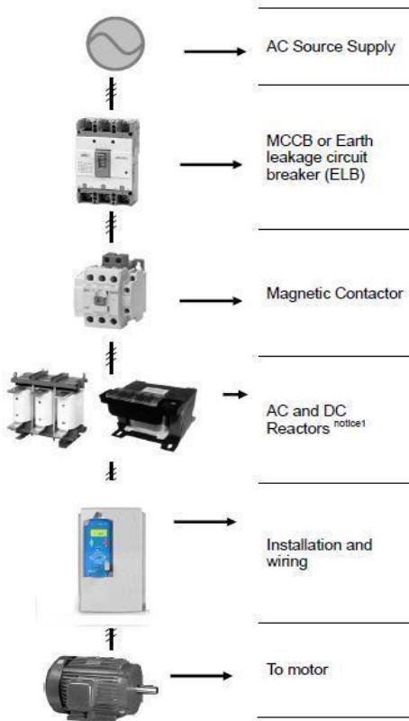
**!** به هیچ عنوان از قطع و وصل برق ورودی "اینورتر" به منظور راه اندازی و توقف الکتروموتور مربوطه استفاده ننمایید. قطع و وصل مکرر ورودی "اینورتر" باعث بروز آسیب اساسی در دستگاه "اینورتر" خواهد شد.
