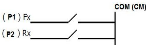
۶- حرکت توسط ورودی‌های RX یا FX و کنترل سرعت توسط جریان آنالوگ ورودی ۰ تا ۴ میلی آمپر
